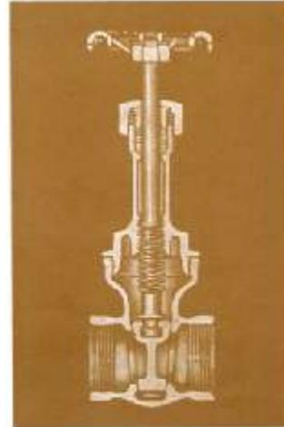
Recomendadas para servicios de alta presión, con vapor, petróleo gas, etc., donde el servicio requiere una construcción más pesada que las conuses o "standard". Todas sus partes son intercambiables, disponiendo existencia de las mismas.
